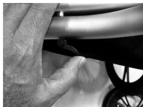
Następnie zamontuj koło, jak pokazano na ilustracji. Otwórz szybkozamykacz osi, aby wsunąć oś w plastikowe końcówki widełek. Dopasuj pozycję płaskich powierzchni na osi do spłaszczeń na końcówkach widełek i wsuń je w otwory. Zamknij dźwignię szybkozamykacza, upewniając się, że jest mocno zaciśnięta. Jeśli koło nadal luźno porusza się w ramie, otwórz dźwignię zwalniającą, dokręć
